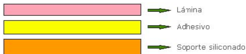
Fig. 2: Estructura del autoadhesivo.
