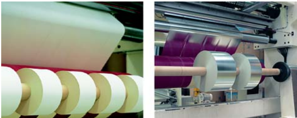
Fig. 14: Detalle de una bobinadora para autoadhesivos.
